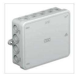
Schutzart IP55, Nennspannung 400 V, Nennquerschnitt 2,5  $\div$  mm², 10 Einführungen für Ø 7-14
